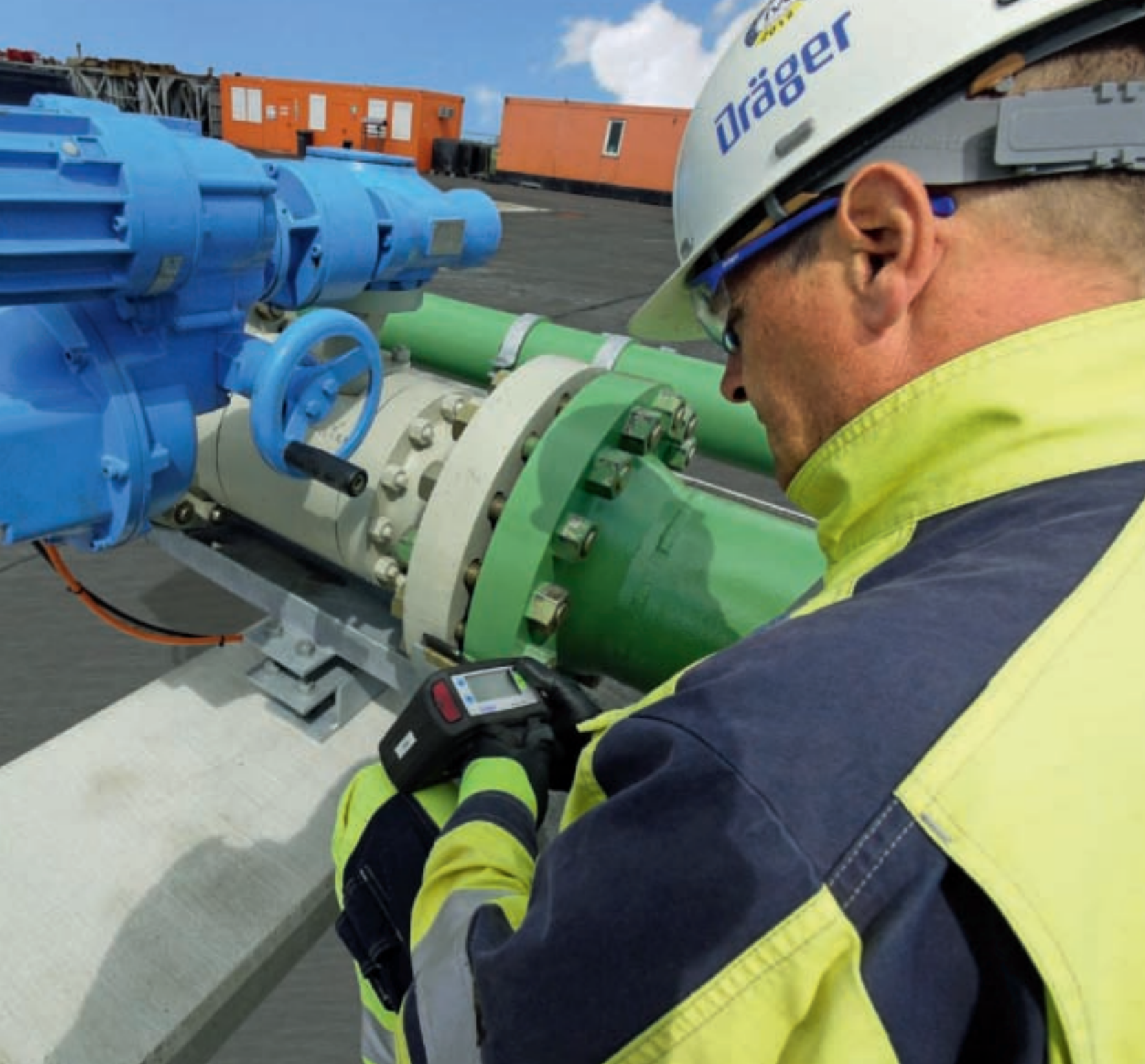
Messen bietet Sicherheit: Bernhard Hamphoff von Dräger misst die Gasfreiheit an einem Flansch in Etzel.
